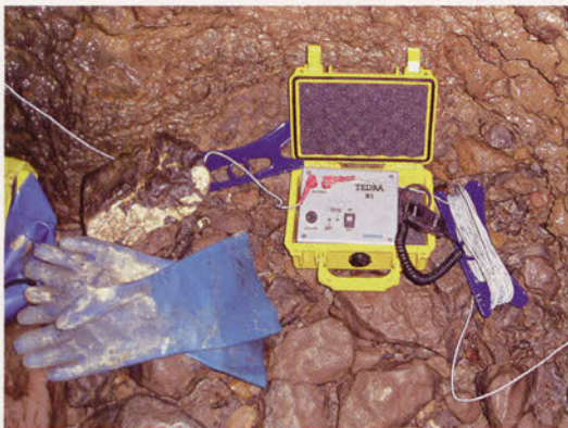
■ Sistema de comunicación subterránea TEDRA (Siemens)
