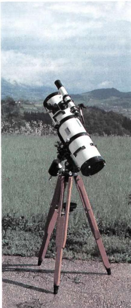
**Telescopio: Telescopio de aficionado. Aparato reflector (con espejos), montura ecuatorial, y trípode de madera.**
