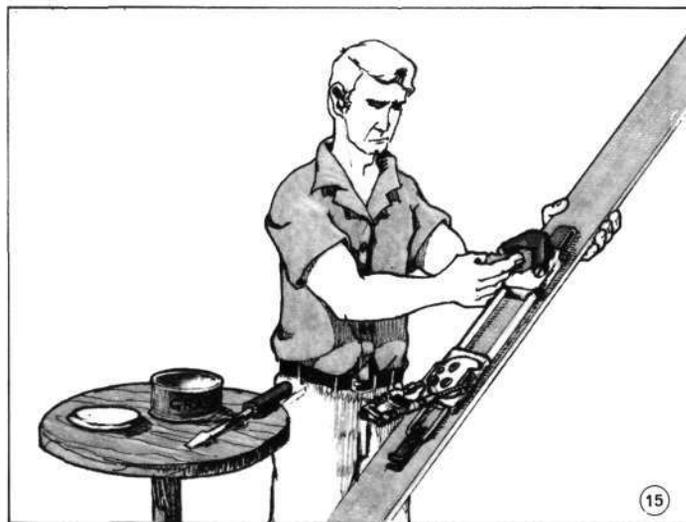
15) Para finalizar este apartado, podemos dar un repaso al resto de las partes: ataduras, tornillos y partes móviles, aplicando grasa consistente en los mecanismos de puntera y talonera (si somos sibaritas, taparemos con trapos estos mecanismos). Un poco de aceite vegetal en un trapo para los cantos, evita la herrumbre en el largo sueño de verano.
