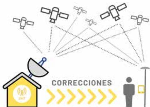
FIGURA 6 · GNSS diferencial. La estación permanente (izquierda) envía correcciones al usuario (derecha). Ambos deben observar un mínimo de satélites en común · FUENTE: Sostremetries 2023
