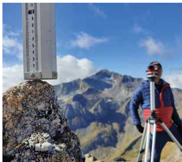
FIGURA 7 · Operador comprobando a través de un nivel óptico si la arista en primer plano es la más alta de la cima · FUENTE: Sostremetries 2023
