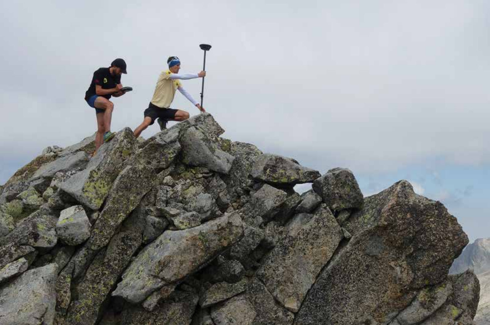
Pedres Albres. Andreu Alvarruiz con la controladora en mano y David Segura colocando el jalón con la antena GNSS sobre el punto más alto.
