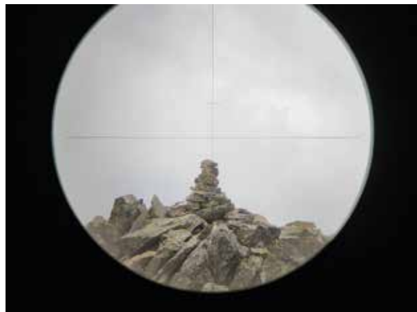
FIGURA 8 · Visor del nivel óptico. La línea horizontal indica que el mojón de piedras está más bajo que el horizonte del observador · FUENTE: Sostremetries 2021
