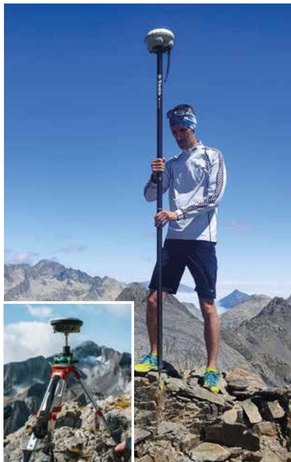
FIGURAS 4 y 5 · Receptor GPS profesional. El disco sobre el extremo superior del jalón y del trípode es la antena · FUENTE: Sostremetries 2023
