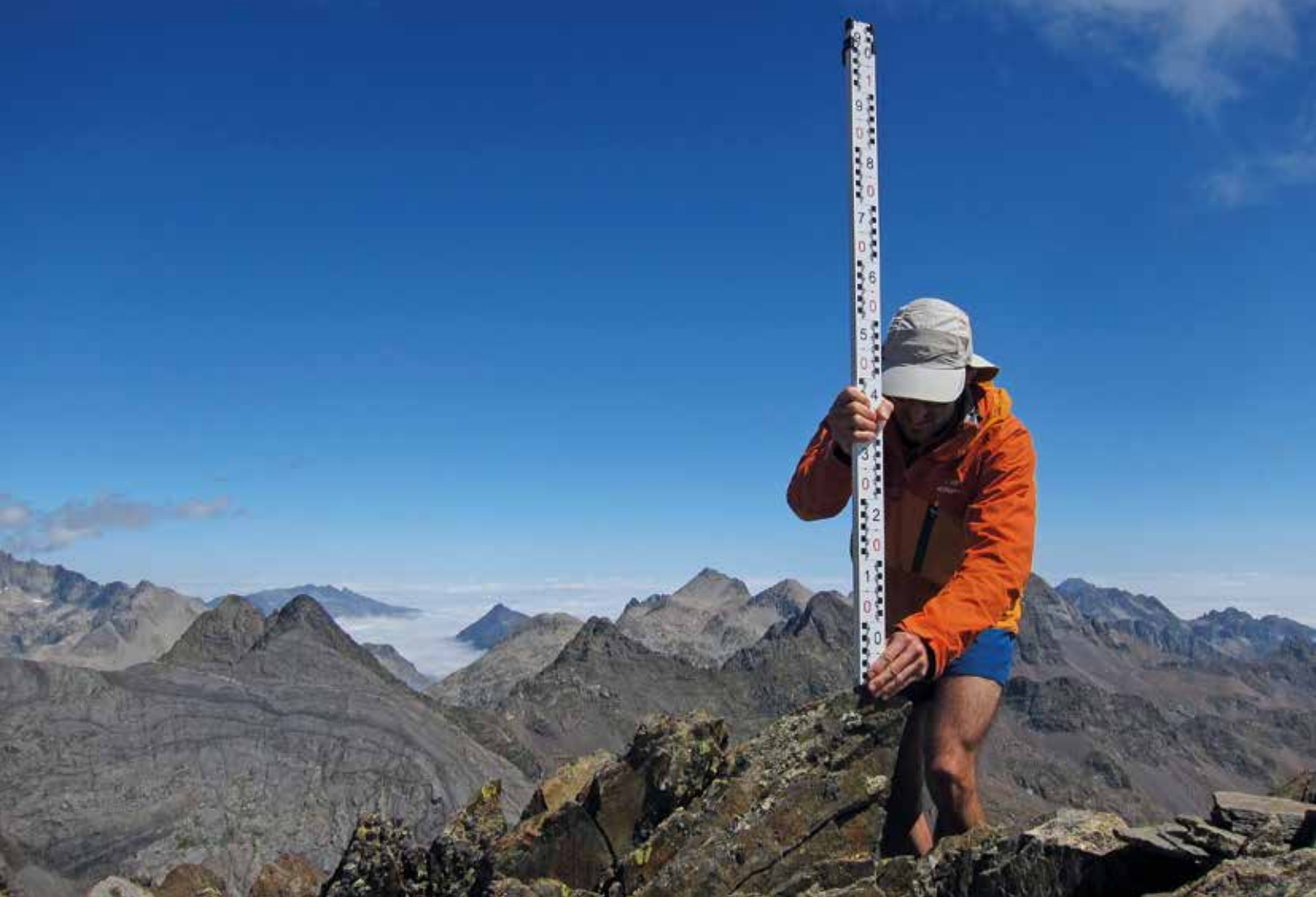
FIGURA 9 · Mira reglada. El operador debe fijarse en que la mira coincida con la línea horizontal de la cruz filar · FUENTE: Sostremetries 2022
